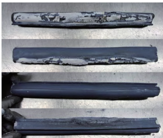
图 9 试验件防火测试后状态
