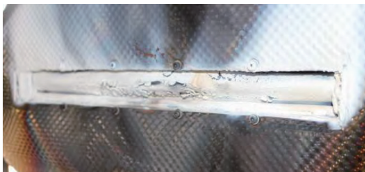
图 8 试验工装防火测试后迎火面状态
