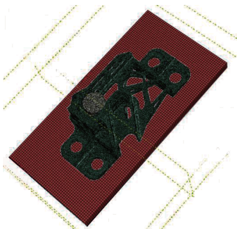
图 4 导向轮槽有限元模型
