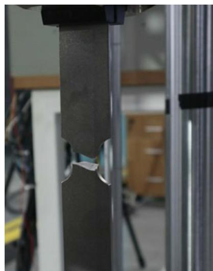
图 2 试验件有效断裂
