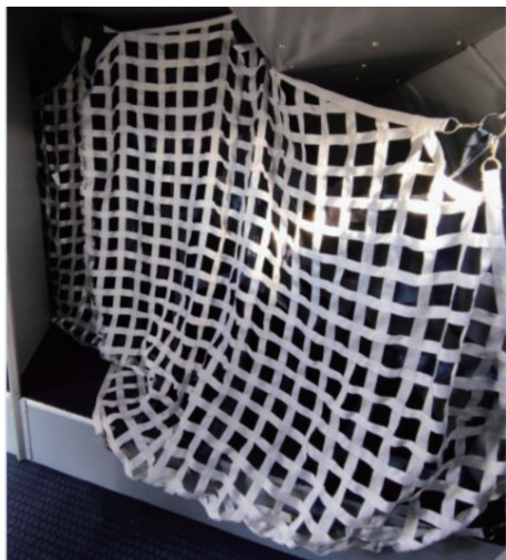
图 7 新增后货舱网格加密行李网装机图
