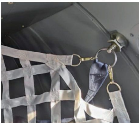
图 8 新增后货舱网格加密行李网固定点安装图
