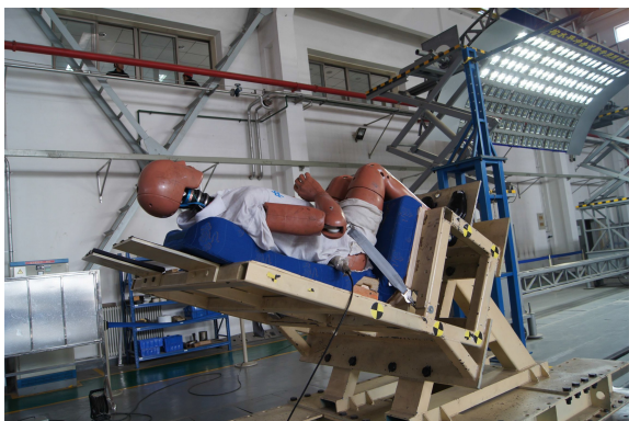
图 2 垂直 14g 冲击试验
