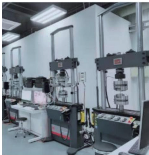
图 2 MTS 疲劳试验机
