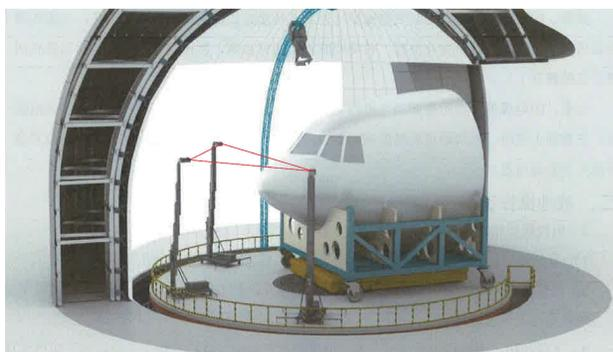
图 4 电动升降系统模拟飞机在云雾中示意图
