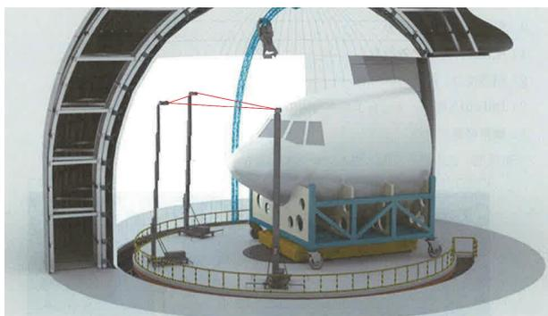
图 3 电动升降系统模拟飞机在云雾下示意图
