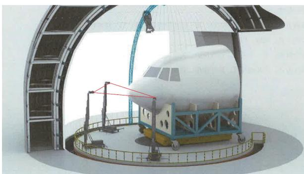
图 5 电动升降系统模拟飞机在云雾上示意图
