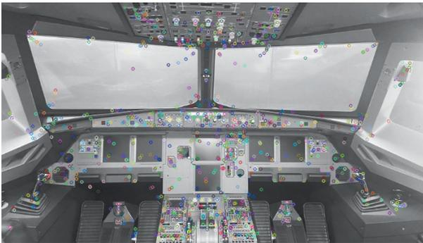
图 4 SURF 算法特征点检测提取
