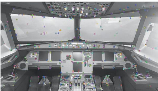
图 6 ORB-SLAM 改进的 ORB 算法特征点检测提取
