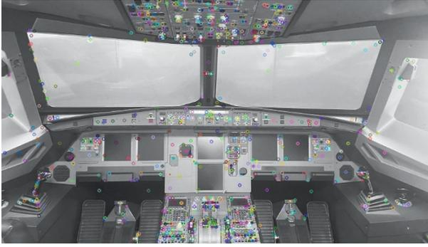
图 3 SIFT 算法特征点检测提取
