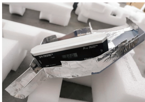
图 6 导流槽安装角度调试
