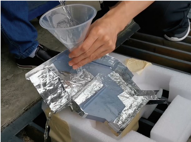
图 7 3D 打印导流槽排液试验过程
