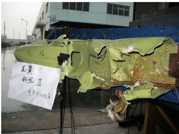
图10 双层蒙皮加强结构试验后状态
