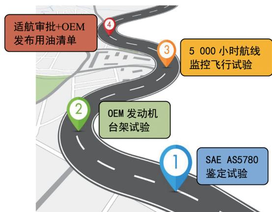
图 1 新型滑油装机取证流程
