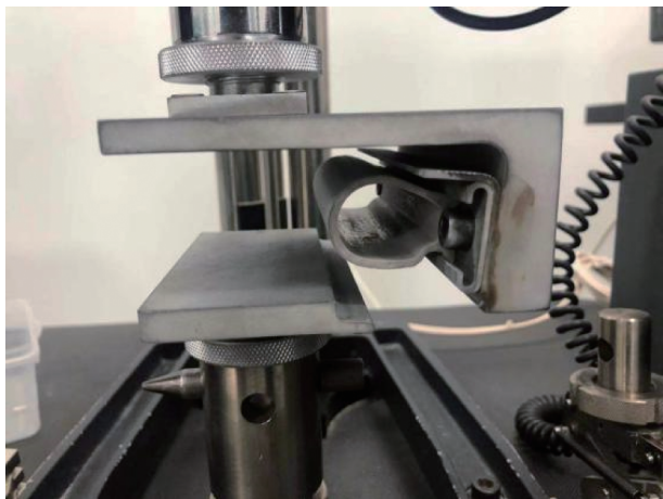
图 8 A-1 舱门密封件样段的成品压缩试验
