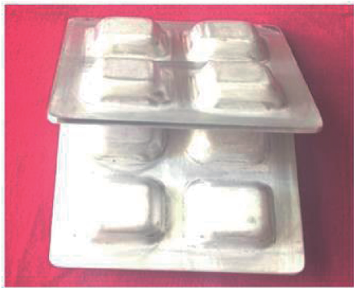
7 5A90 铝锂合金 SPF/DB 中空双层结构件 [15]
