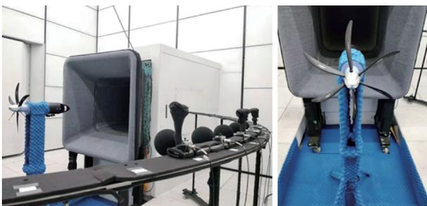
(b) 螺旋桨气动噪声实验测量
