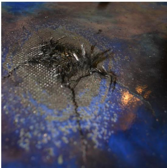
图 8 6 层、235  $\mu\text{m}$  漆层厚度试验损伤情况
