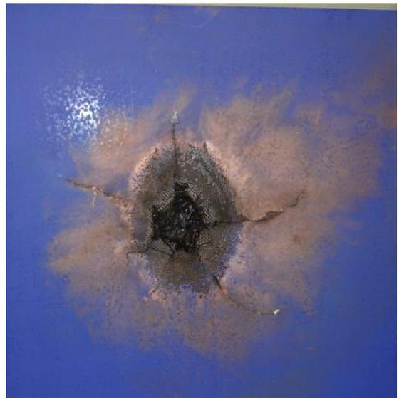
图 10 6 层、256  $\mu\text{m}$  漆层厚度试验损伤情况
