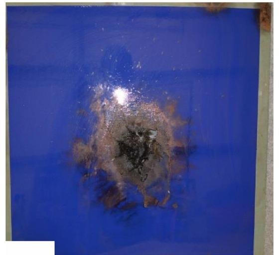
图 11 7 层、256  $\mu\text{m}$  漆层厚度试验损伤情况
