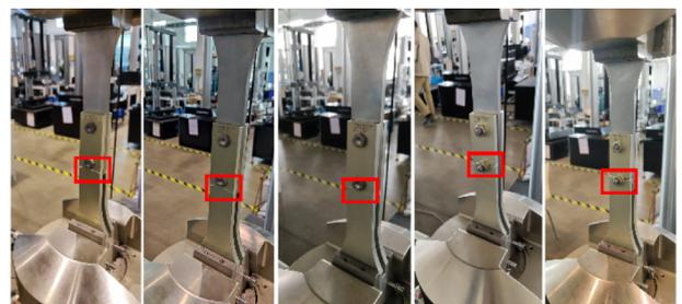
图 6 01 类试验件 60 MPa 载荷下失效破坏位置
