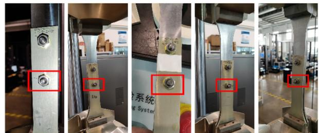
图10 03类试验件110 MPa 载荷下失效破坏位置
