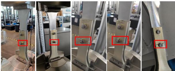
图 5 01 类试验件 75 MPa 载荷下失效破坏位置
