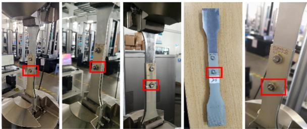
图7 02类试验件90 MPa 载荷下失效破坏位置
