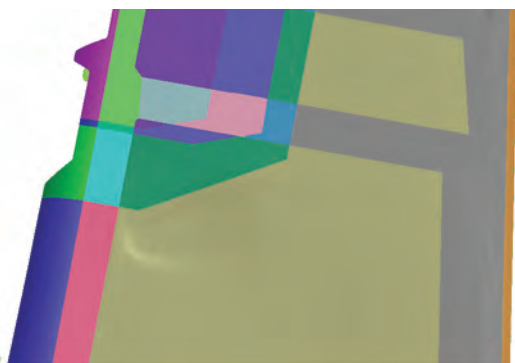
图 10 鸟撞后方向舵局部视图(典型工况)
