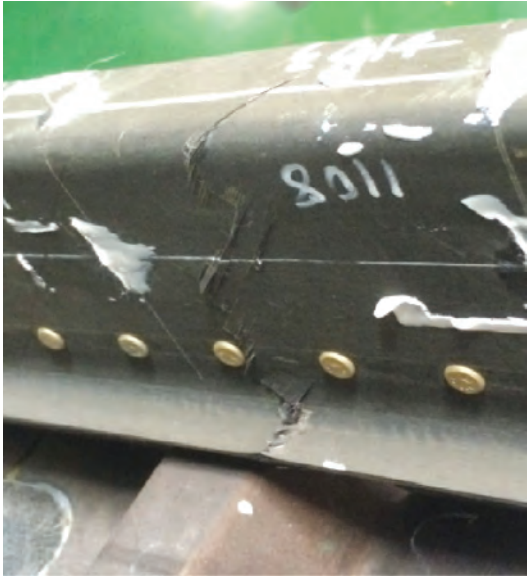
图 8 试验破坏部位
