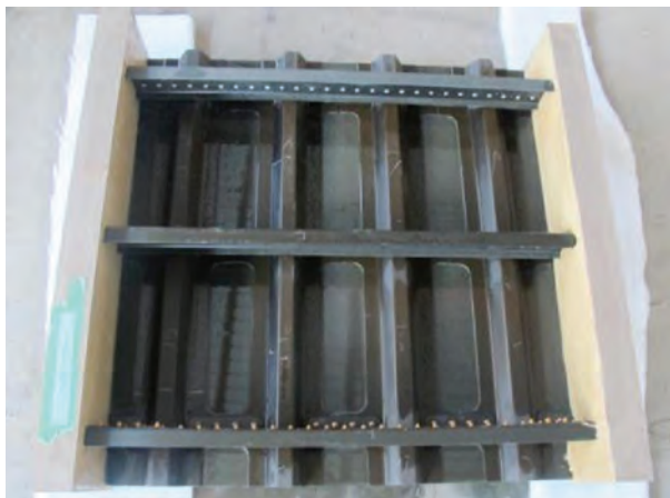
图 1 复合材料机身框轴向压缩试验件
