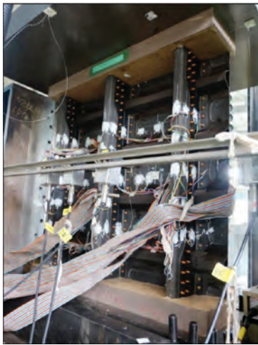
图 4 试验件支持和加载方式图
