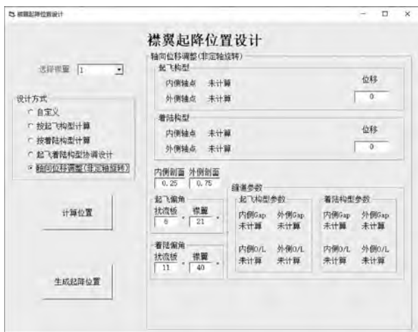
图 14 襟翼按轴位移方式设计起降位置界面
