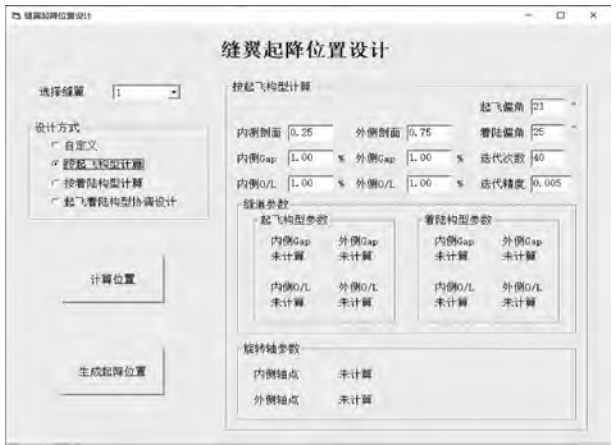
图 11 缝翼按起飞位置设计起降位置界面
