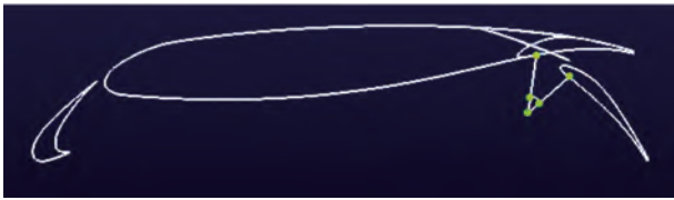
图 3 原始翼型与偏转后的翼型
