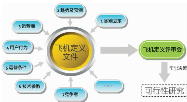
图5 市场分析与飞机定义阶段工作流程
