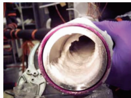
图 1 燃油系统管路结冰现象
