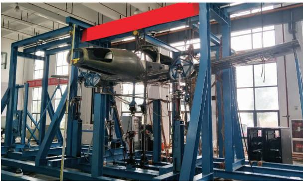
图9 CA42飞机全机疲劳试验
