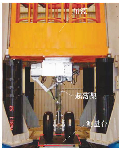
图 3 某型民机起落架落震试验照片
