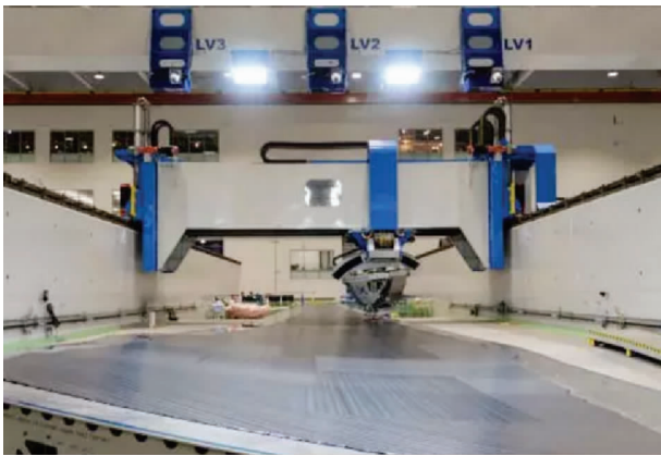
图 4 窄带铺放制造波音 777X 机翼蒙皮
