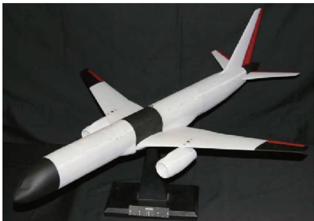
图 5 某波音客机自由尾旋试验模型
