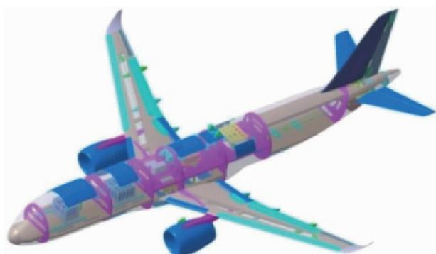
图 6 某大型民用飞机尾旋试验 3D 模型
