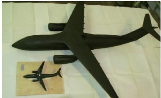
图4 安东诺夫 An-148 客机自由尾旋试验模型
