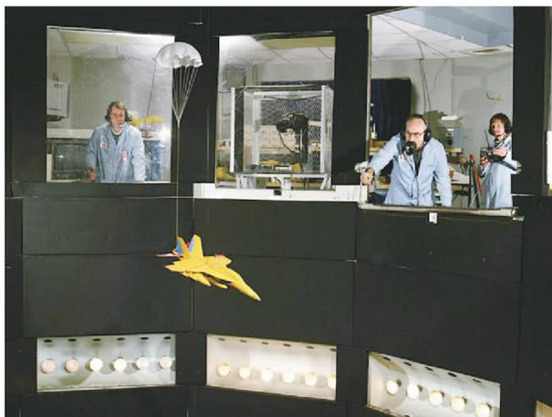
图 9 某飞机模型反尾旋伞试验
