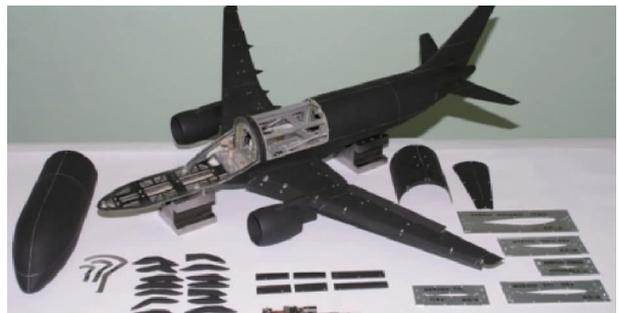
图3 苏霍伊 SSJ 客机自由尾旋试验模型
