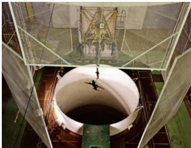
图 14 TsAGI 尾旋风洞民机旋转天平试验
