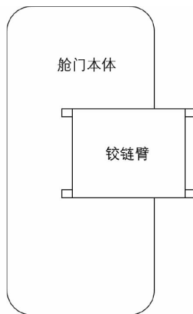
图 1 登机门铰链臂轮廓示意
