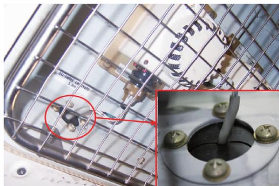
图 5 某飞机货舱烟雾探测器罩线缆开孔封堵形式
