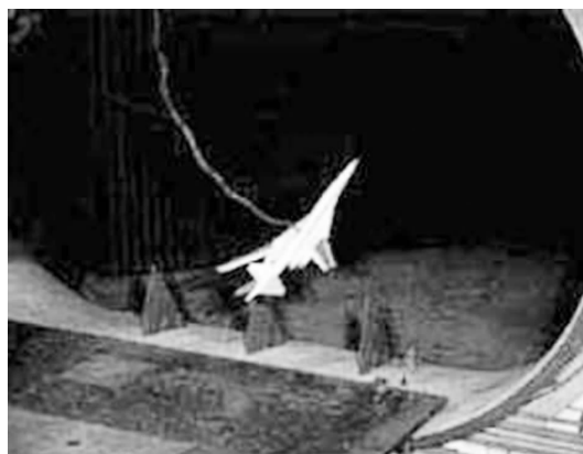
图 5 波音 733 超音速旅客机风洞自由飞试验
