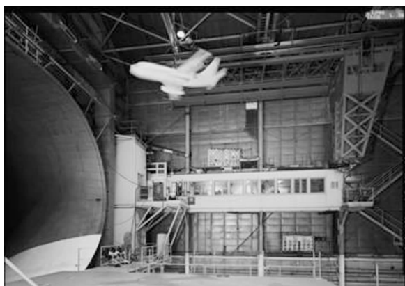
图7 波音737中型旅客机风洞自由飞试验
