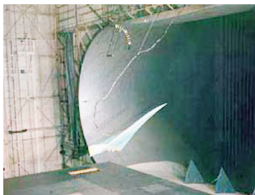
图 4 L-2000 超音速旅客机风洞自由飞试验
