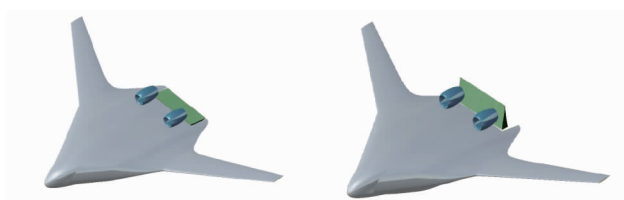
(a) 常规状态 (b) 减速状态
