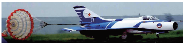
(b) 利用减速伞实现飞机着陆减速
