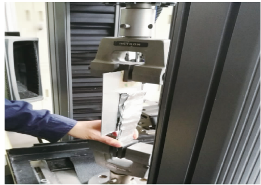
图3 3M-363 + 铝板剥离试验
