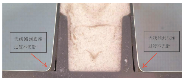
图 2 VHF 通信天线横向结构剖面图
