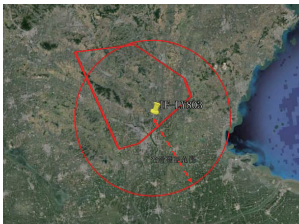
图 1 某试验点空滑覆盖范围和试验空域
