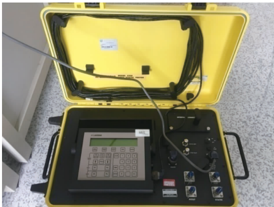
图3 大气数据测试装置
