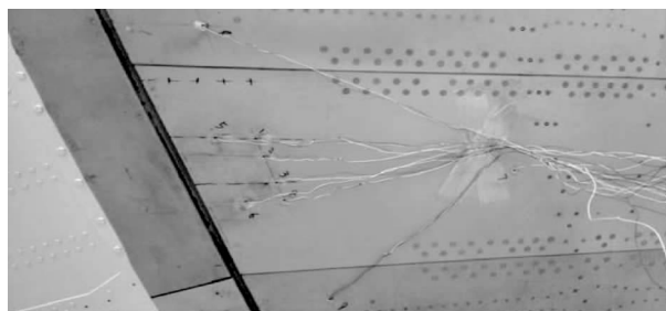
图6 机翼根部强迫装配尝试的应变测量
