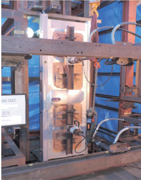
图2 驾驶舱门静力试验
