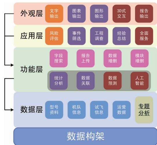
图 1 持续适航工程数据库基础架构的数据架构
