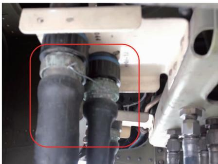
图1 起落架舱插头外表面腐蚀现象
