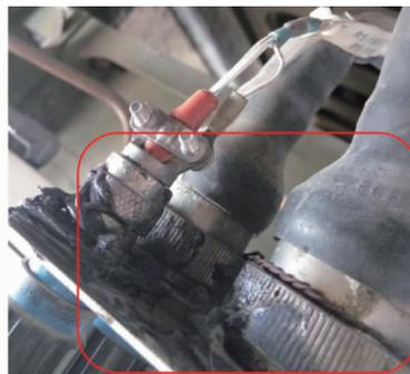
图2 襟缝翼插头外表面腐蚀现象
