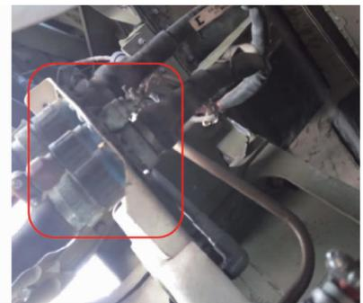
图3 平尾区域插头外表面腐蚀现象
