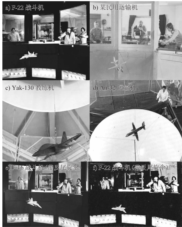
图3 模型进行尾旋特性与改出特性试验
