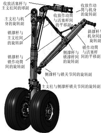
图2 主起机构运动副约束示意图
