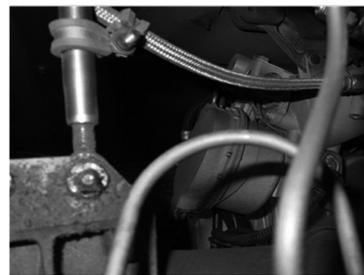
图 3 A320 飞机空调系统的流量控制活门的位置细节示意
