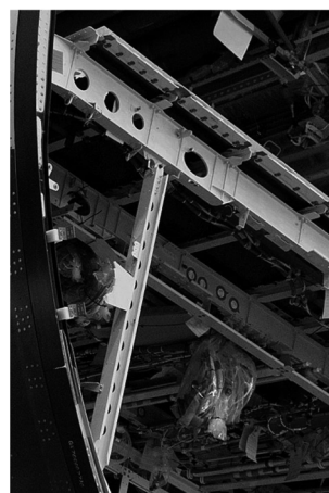
图9 A350 地板横梁形式及其与座椅滑轨的连接
