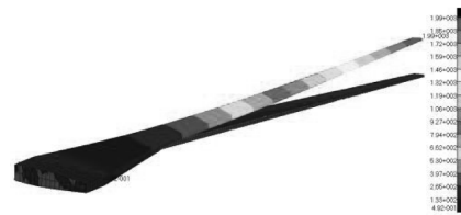
图13 复合材料双梁式机翼盒段位移云图
