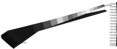
图11 宽体客机双梁式金属机翼盒段位移云图
