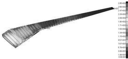
图10 宽体客机双梁式金属机翼盒段应力云图
