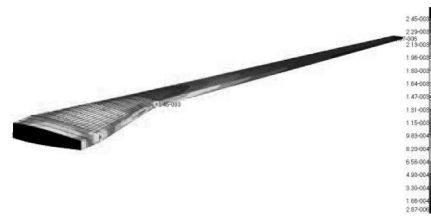
图12 复合材料双梁式机翼盒段应变云图
