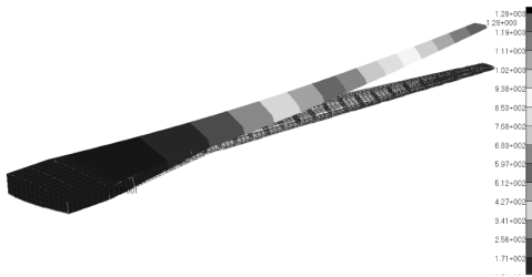
图9 窄体客机双梁式金属机翼盒段位移云图
