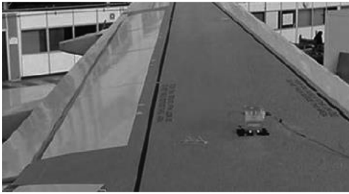
图3 蒙皮电流测量实例
