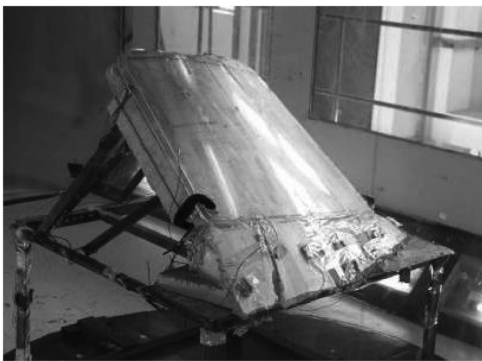
图 1 风挡在低速风洞中的安装示意图
