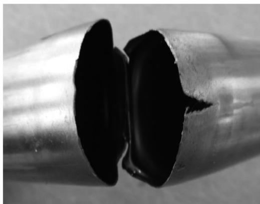
图1 导管破裂图
