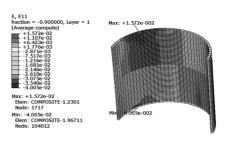
图 14 双剪试验件初始破坏应变云图
