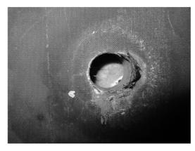
图 8 孔壁挤压破坏模式
