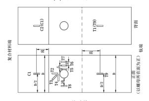
(b) 双剪贴片图 图 3 试验件贴片示意图
