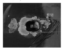
图 7 试板挤压-剪切破坏模式
