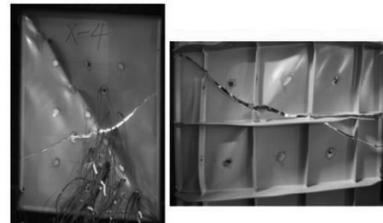
图 27 1 型试验件的破坏模式示意图
