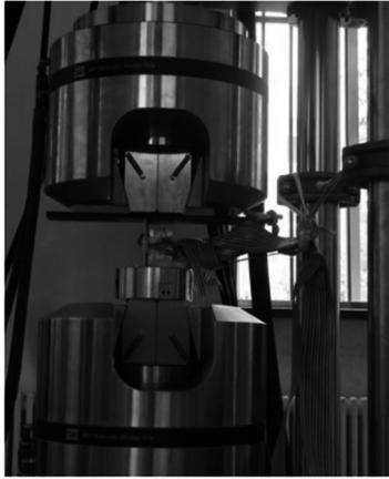
图5 T型、Z型长桁试验件安装
