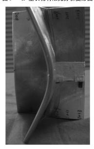
图 10 "T"型长桁典型试验破坏照片
