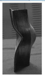
图 8 "Z"型长桁典型试验破坏照片
