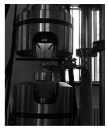
图 7 "T"型、"Z"型长桁试验件安装照片 表 2 压损试验结果
