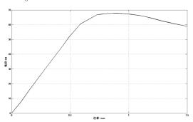
图 5 "Z"型长桁载荷-位移曲线
