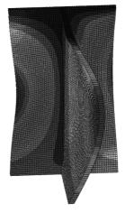
图 11 "T"型长桁有限元分析变形图
