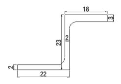
图 2 "Z"型长桁横截面示意图
