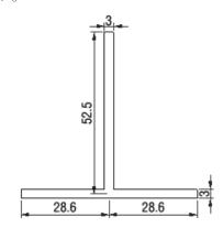
图 1 "T"型长桁横截面示意图
